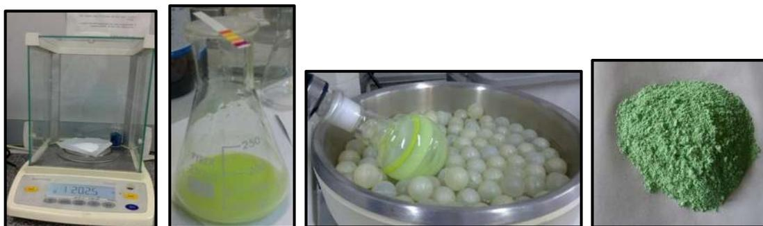
**Figura 9.** Impregnación de los metales (NiMoW) por el método de humedad incipiente.
