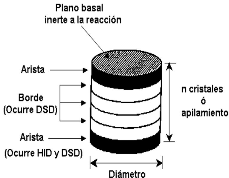
**Figura 5.** Modelo “arista-borde” para sulfuros de metales de transición no promovidos (Chianelli, 1994).
