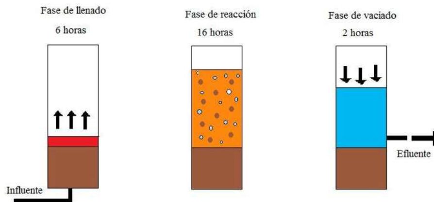
Figura 3.5 Esquema de las fases de operación del reactor tipo ASBR
