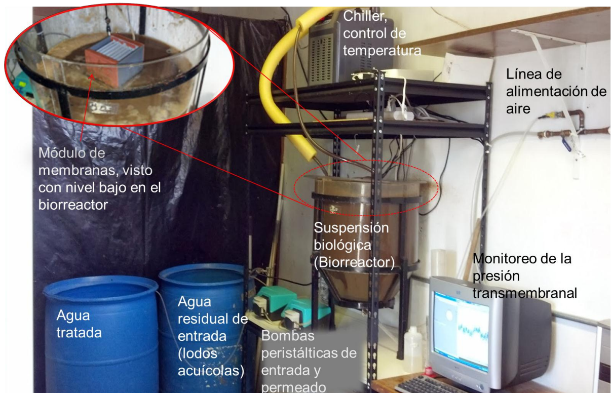
Figura 5.2. BRM escala laboratorio utilizado en el experimento
