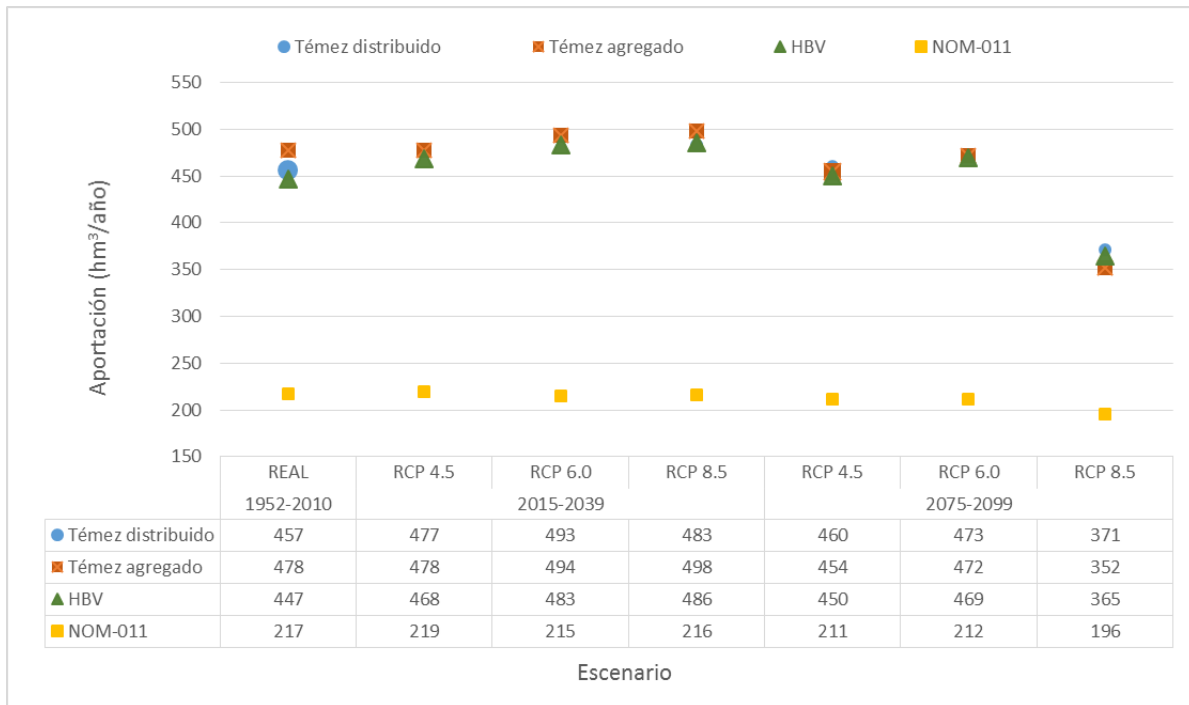
Figura 7.83 Comparativa de los volúmenes obtenidos con los diferentes modelos hidrológicos para los escenarios actual y de cambio climático, para los periodos de 1952-2010 (actual), 2015-2039 y 2075-2099 (proyecciones de cambio climático).
