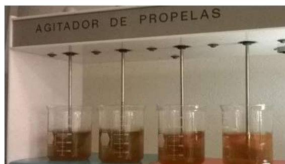
Figura 10. Equipo de propelas utilizado para los experimentos de degradación.
