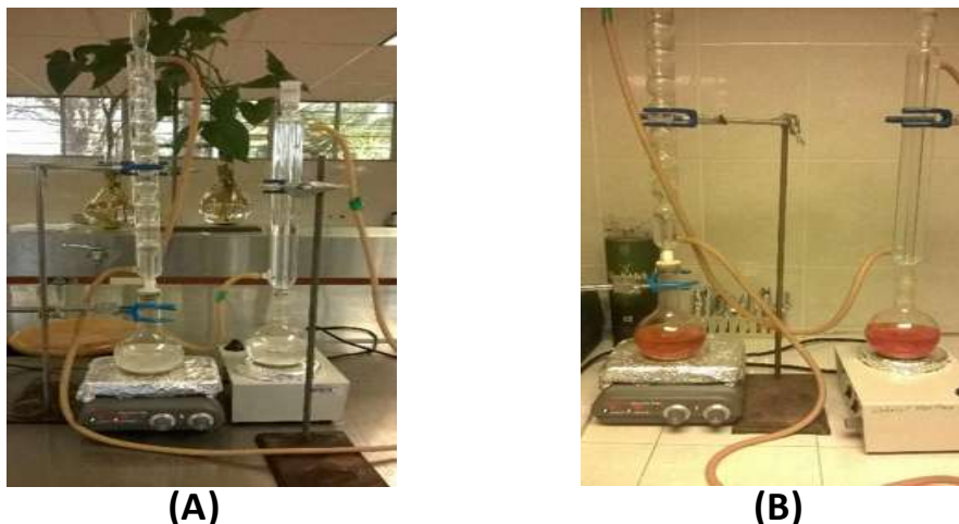
Figura 11. Equipo de reflujo utilizado para la modificación de la zeolita con cloruro de sodio (A) y posteriormente con cloruro férrico (B).
