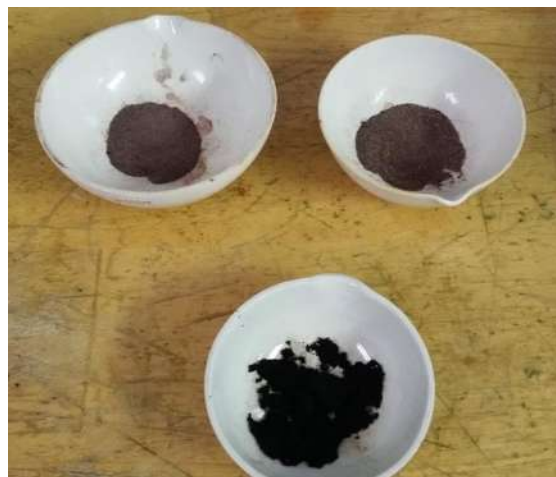
Figura 13. Impregnación y secado de los catalizadores RuMoNi .
