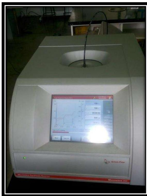
FIGURA 14. Reactor de Microondas Anton Paar.
