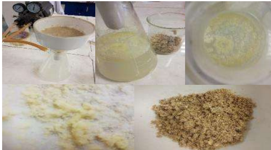
Figura 14. Proceso de deslipidación de la semilla de Moringa
