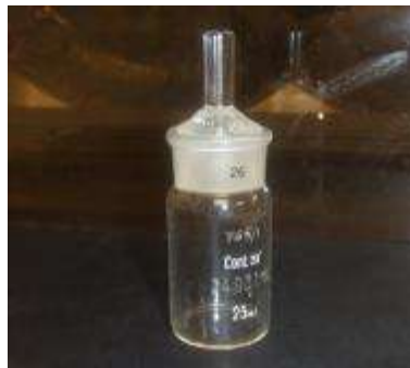
Figura 22. Picnómetro para determinación de la densidad
