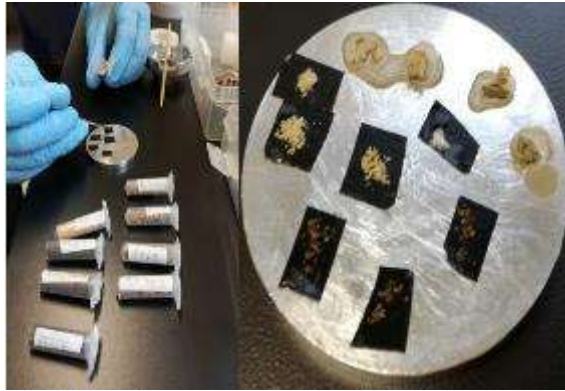
Figura 18. Preparación de muestras para MEB.
