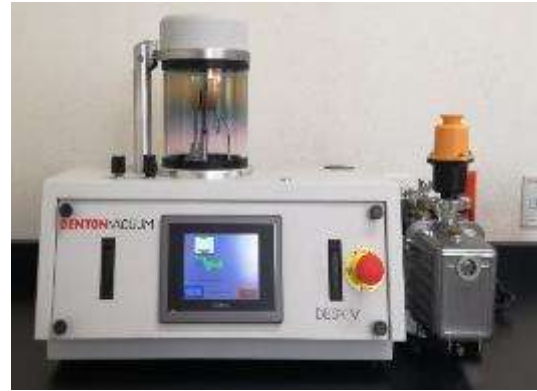
Figura 19. Evaporador para recubrimiento de muestras
