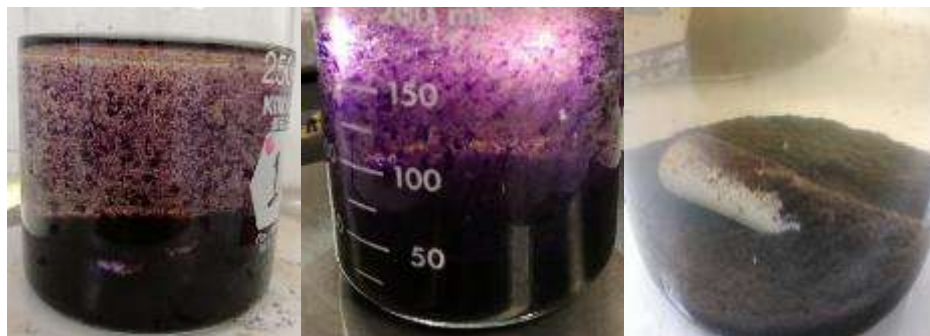
Figura 29. Apariencia de los flóculos y sedimento con Moringa - \text{Fe}_2(\text{SO}_4)_3 a 50 mg/L.
