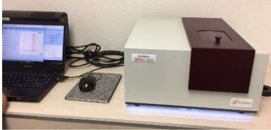
Figura 16. Zetámetro para medición de PZ y pH pzc
