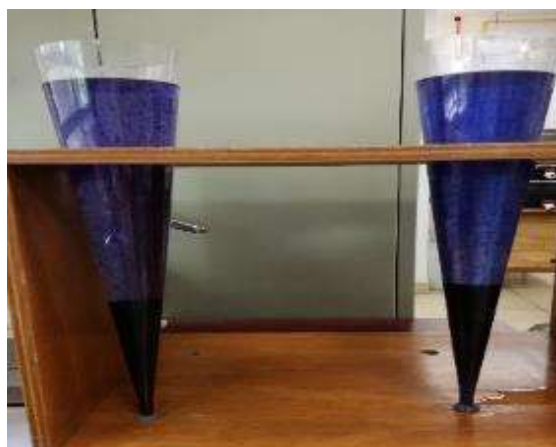
Figura 36. Prueba para determinación de Índice Volumétrico de Lodos
