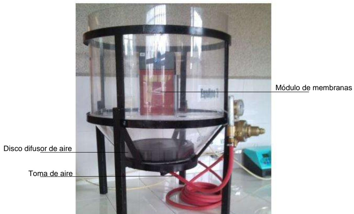
**Figura 4.1.** Biorreactor con membranas sumergidas.
