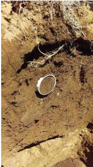
Figura 26. Método del cilindro para extraer muestra de Dap.
