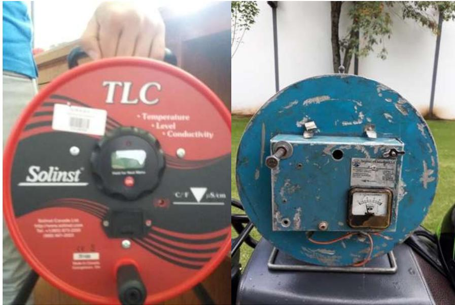
Figura 59. Medidores para nivel piezométrico.
