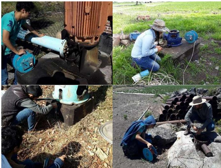
Figura 60. Medición de niveles piezométricos en diversos pozos.
