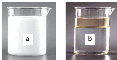
Figura 4.6. Estabilidad de la solución al 2.0 %wt de span 85 empleando. a). Emulsión recién agitada, b). 10 segundos después de la agitación.
