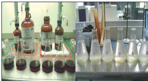
Figura 4.15.- Determinación de glicerol libre y glicerol total
