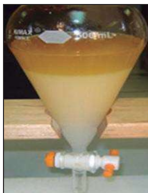
Figura 4.13.-Lavado del biodiesel
