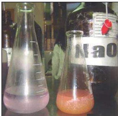
Figura 4.7.- Determinación de los ácidos grasos libres
