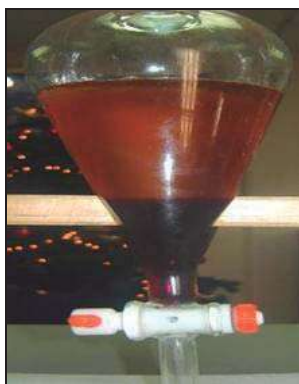
Figura 4.12.- Decantación del glicerol
