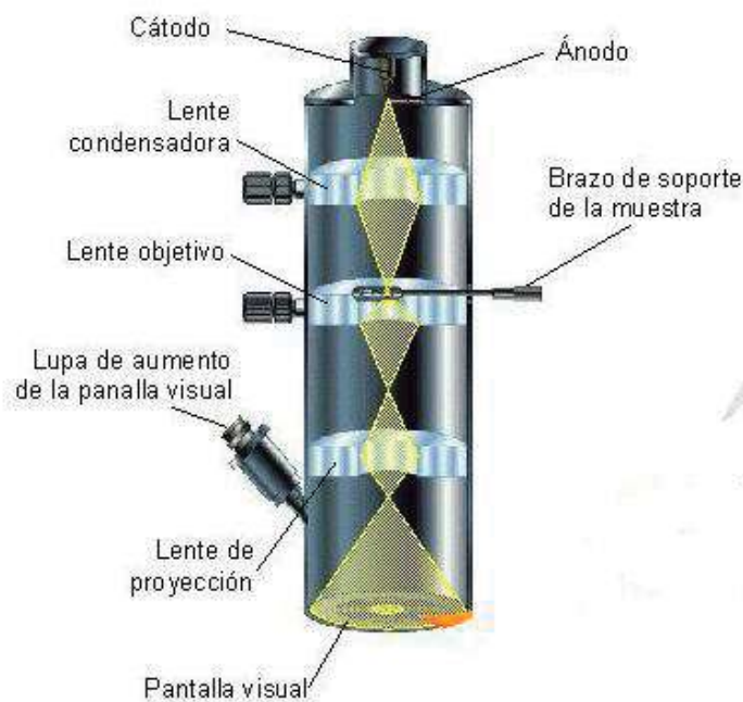
Figura Ap. 1.3. Esquema de un microscopio electrónico de transmisión
