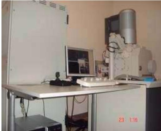
**Figura 3.4** Microscopio HR FEG-Nova 600 Nano SEM.
