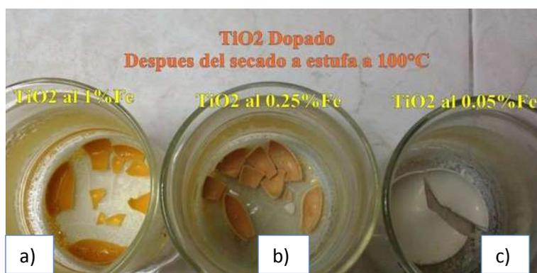
**FIGURA 14.- Muestra de  $\text{TiO}_2$  dopado después de la etapa de secado.**
