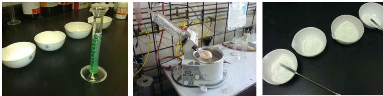
Figura 26. Impregnación simultánea de la solución al soporte.
