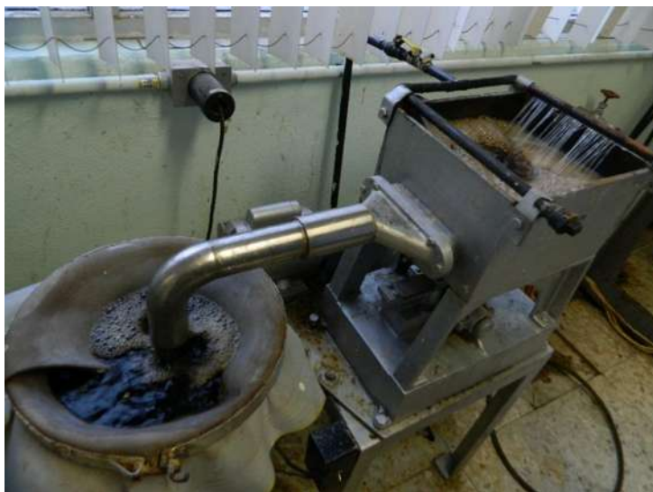
Figura 3.4 Depurador y lavador de pulpa.
