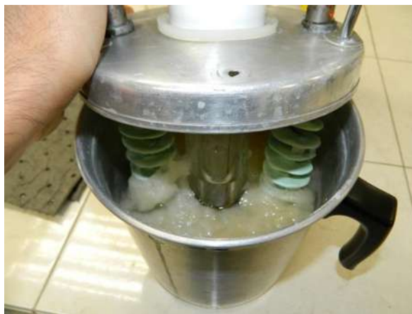
Figura 3.7 Reactor modificado para pulpa celulósica.
