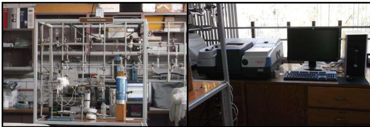
Figura 3.4 Sistema de alto vacío (izquierda) para degasificación y espectrofotómetro FT-IR (derecha).
