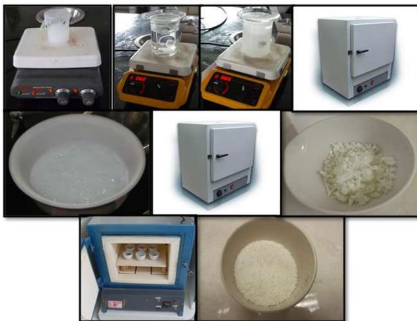
Figura 3.2 Esquema general de la síntesis de los catalizadores SBA-15 y Al-SBA-15.
