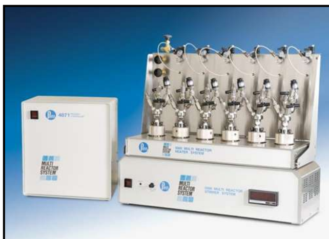
Figura 3.5 Sistema múltiple de reactores.
