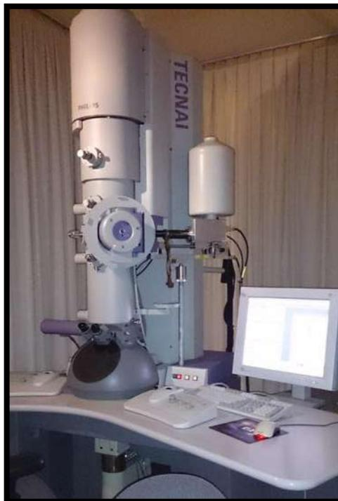
Figura 16. Microscopio Electrónico de Transmisión Philips Tecnai TF-20.
