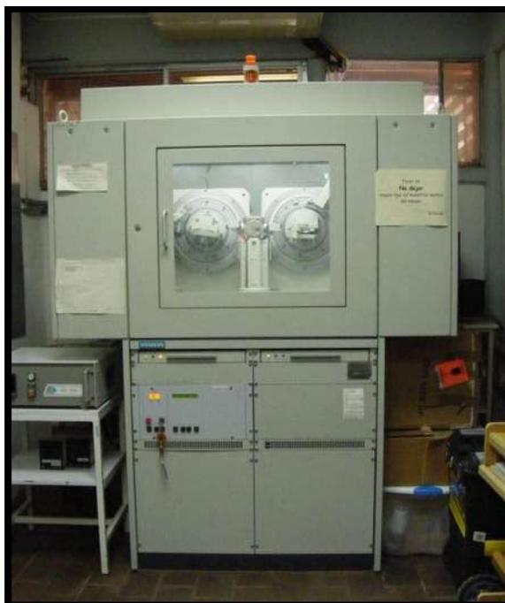
Figura 15. Equipo de Difracción de Rayos X Siemens D – 5000.
