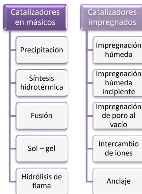
Figura 55. Diagrama de métodos de preparación de catalizadores.
