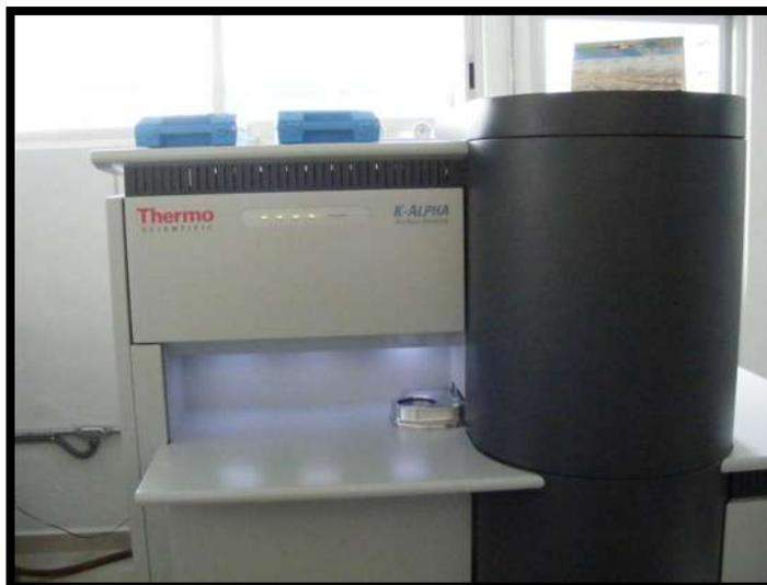
Figura 17. Equipo de espectroscopia de fotoelectrones de rayos X.
