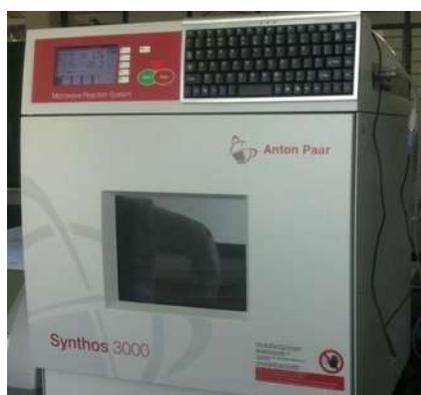
**Figura 7-2.** Reactor de microondas Anton Paar, modelo Synthos 3000.
