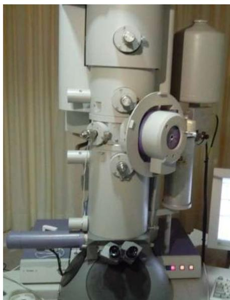
**Figura 7-6.** Microscopio electrónico de transmisión Philips, modelo TECNAI TF20.
