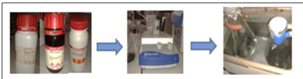
Figura 21. Preparación de la mezcla de precursores, surfactante y NTC.
