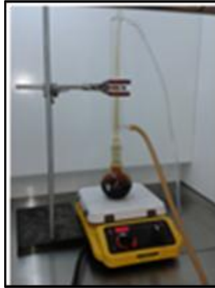
Figura 18. Sistema de reflujo por 8 horas, utilizando parrilla eléctrica.
