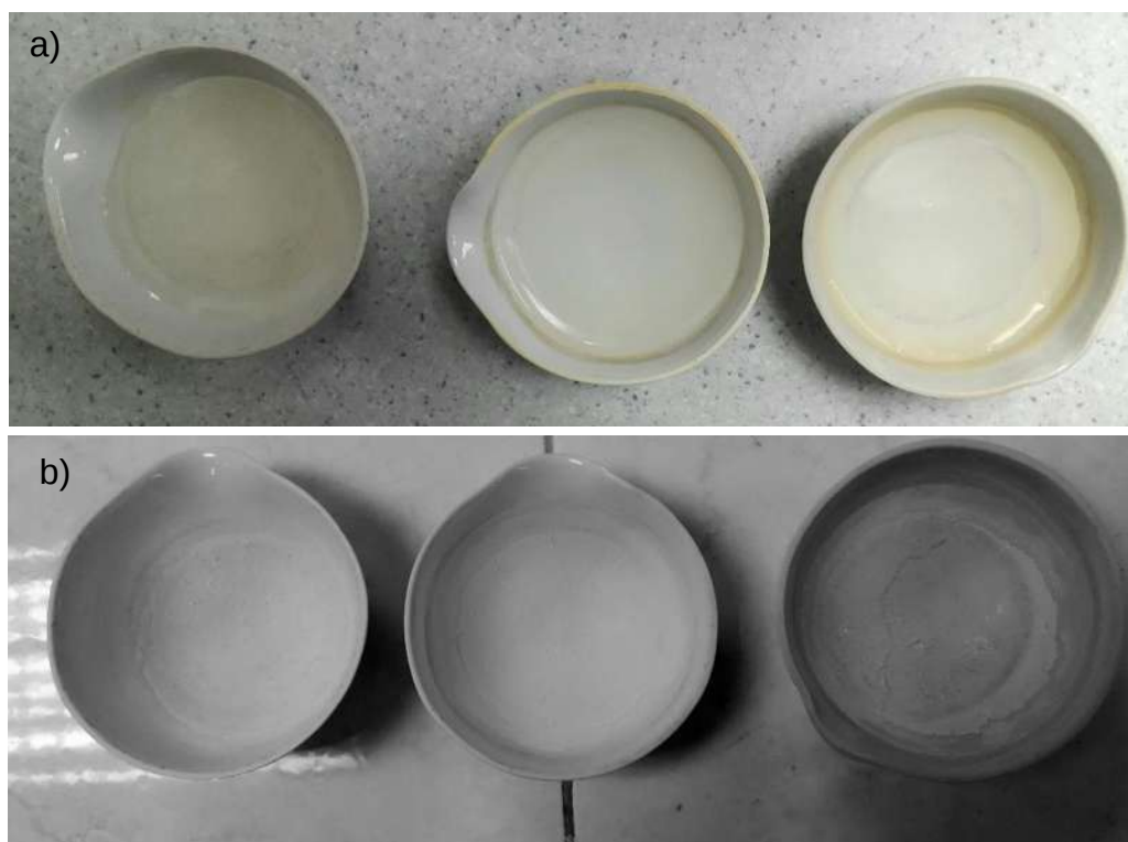
Figura B.1 Alícuotas del sobrenadante. a) Antes del secado b) Después de la calcinación
