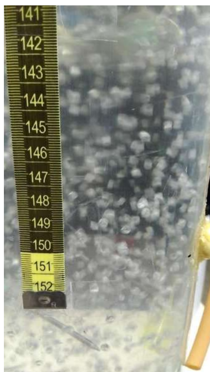
Figura 4.4 Burbujas dentro del reactor de columna de burbujeo.
