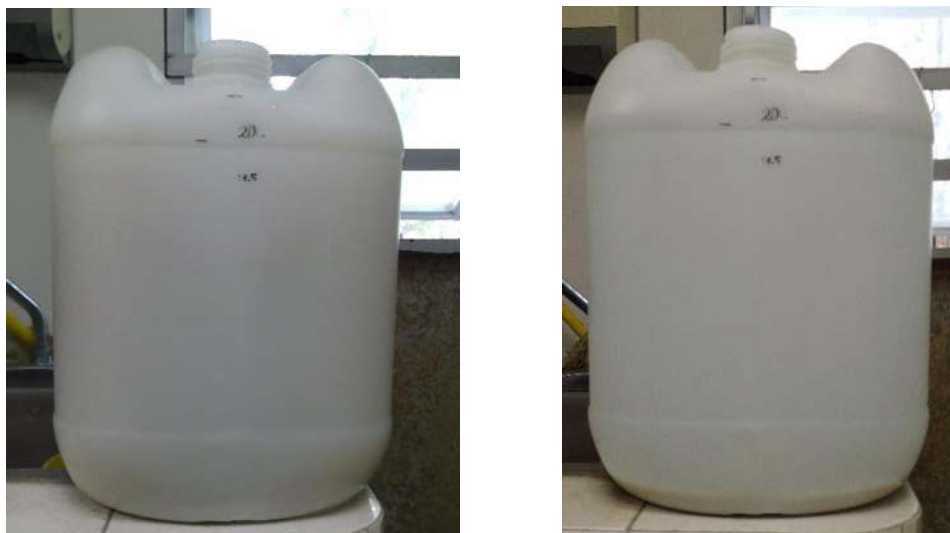
Figura 3.4 Preparación de la solución de \text{Ca}(\text{OH})_2 . a) Antes de precipitar. b) Después de precipitar.
