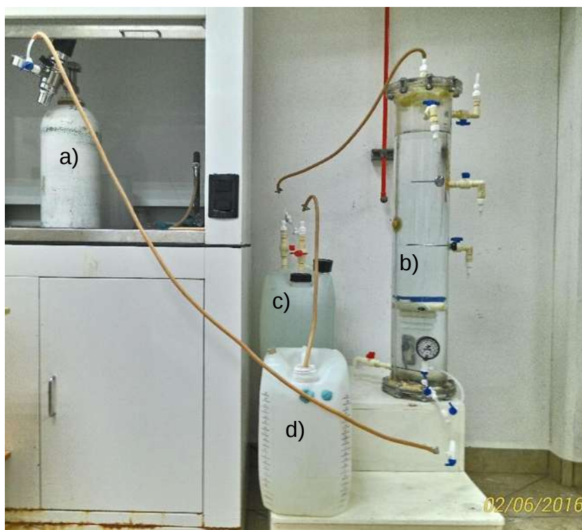
Figura 4.2 Tanque de medición de gases. a) entrada de gas b) salida de agua c) punto de muestreo.
