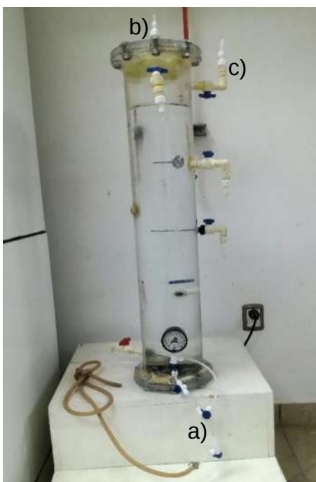
Figura 4.1 Reactor de columna de burbujeo. a) entrada de gas. b) salida de gas. c) entrada de líquido.
