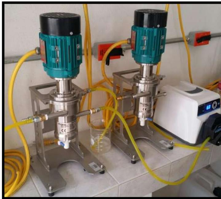
**Figura 3.3 Separador contactor centrífugo CINC V02**
