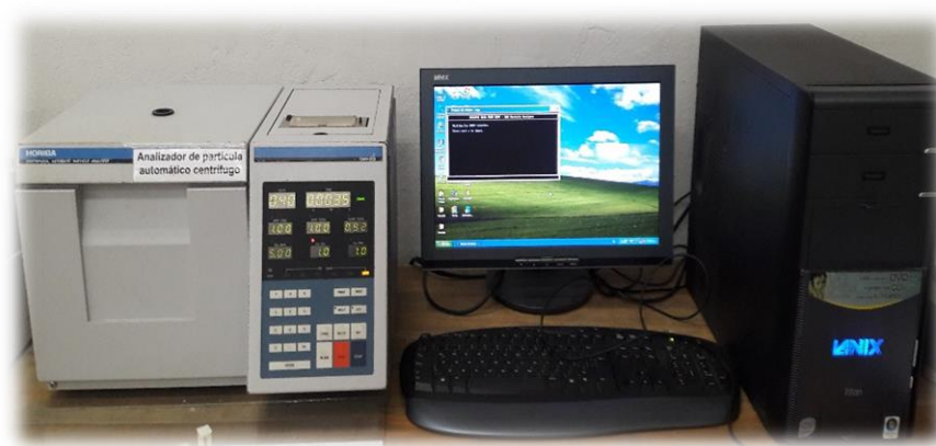
Figura 7. Equipo analizador de tamaño de partícula automático centrífugo Horiba Capa-300.
