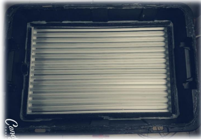
Figura 12. Vista superior del reactor (zona de deflectores).
