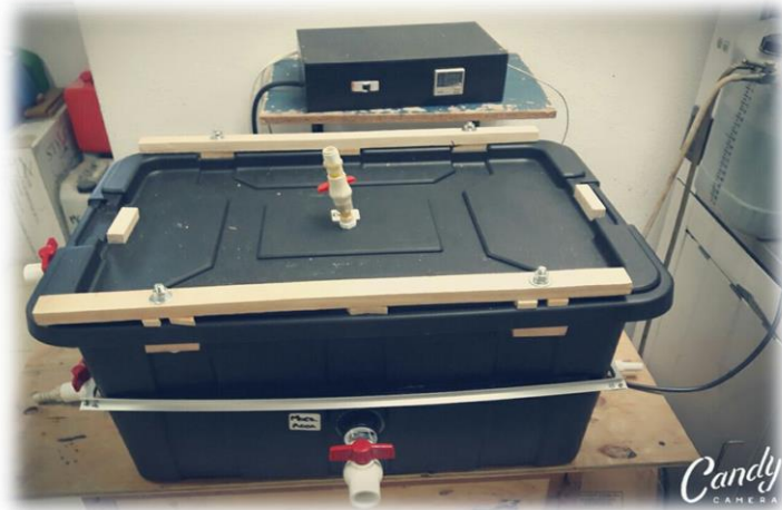
Figura 13. Construcción de Reactor UASB finalizada.
