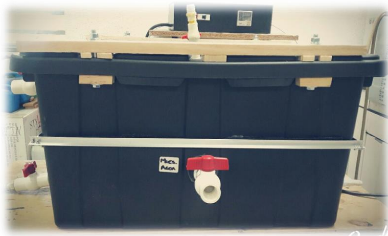
Figura 9. Vista frontal del reactor UASB.
