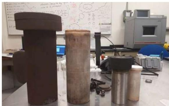
**Figura 3.1** Autoclaves y viales de teflón utilizados en la síntesis hidrotérmica
