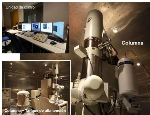
**Figura 3.5** Microscopio Electrónico de Transmisión (Paraguay, 2018)
