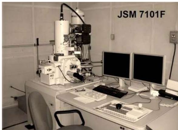
**Figura 3.4** Microscopio Electrónico de Barrido (Paraguay, 2018)
