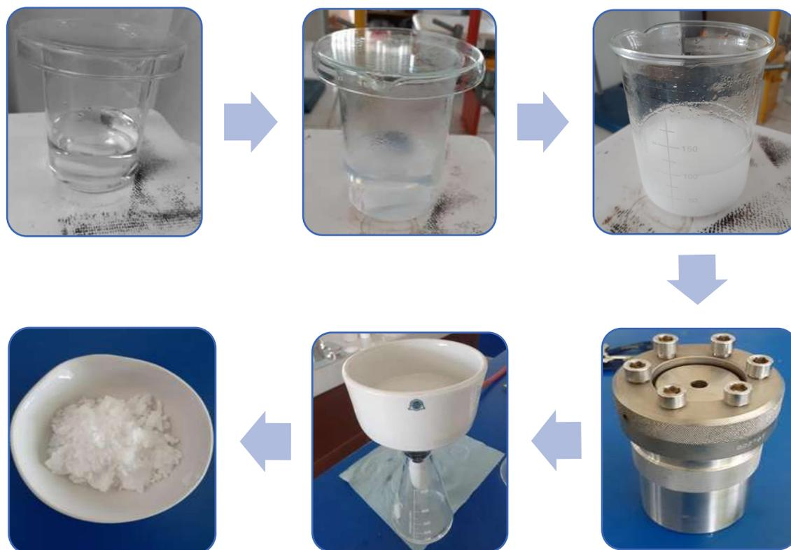
**Figura 13.** Proceso de síntesis de los catalizadores.
