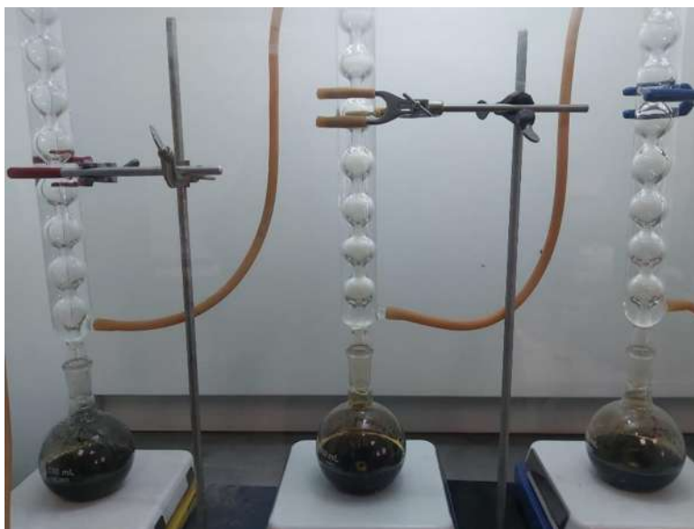
Fig. 53. Matrices con la mezcla de \text{HNO}_3 y \text{H}_2\text{SO}_4 y refrigerantes en serie
