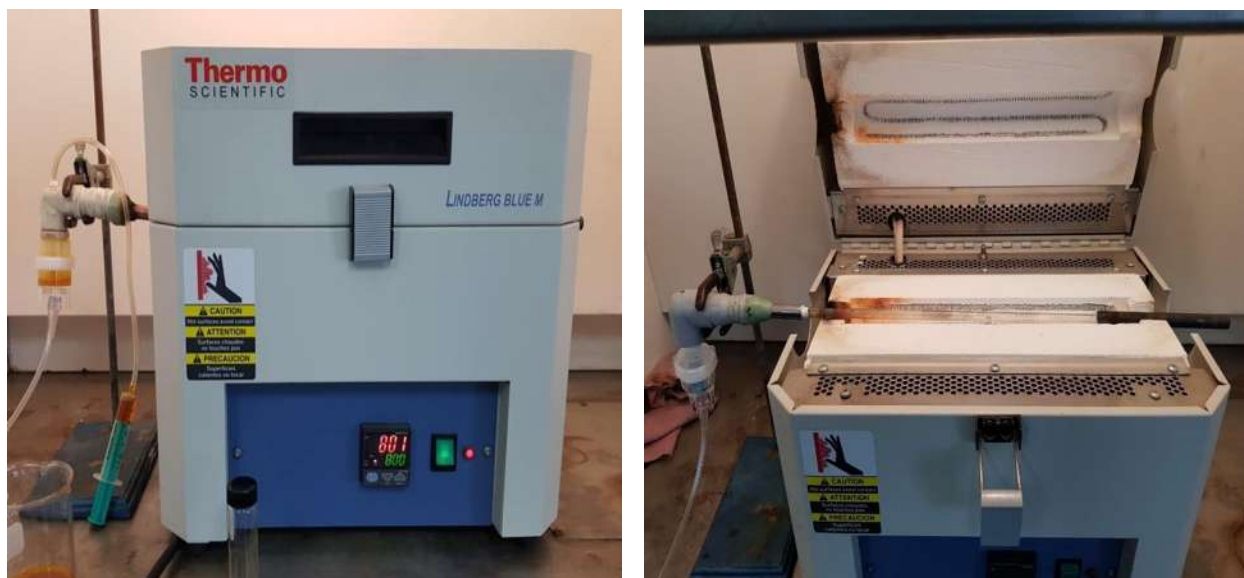
Fig. 45. Horno tubular donde se realizará el crecimiento de NTC
