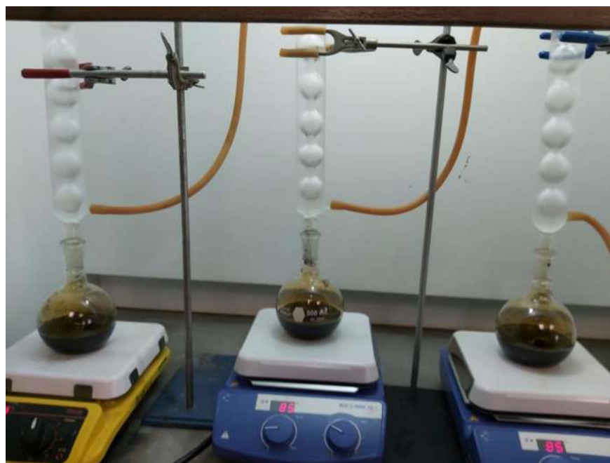
Fig. 51. Montaje de sistema de refrigerantes en serie
