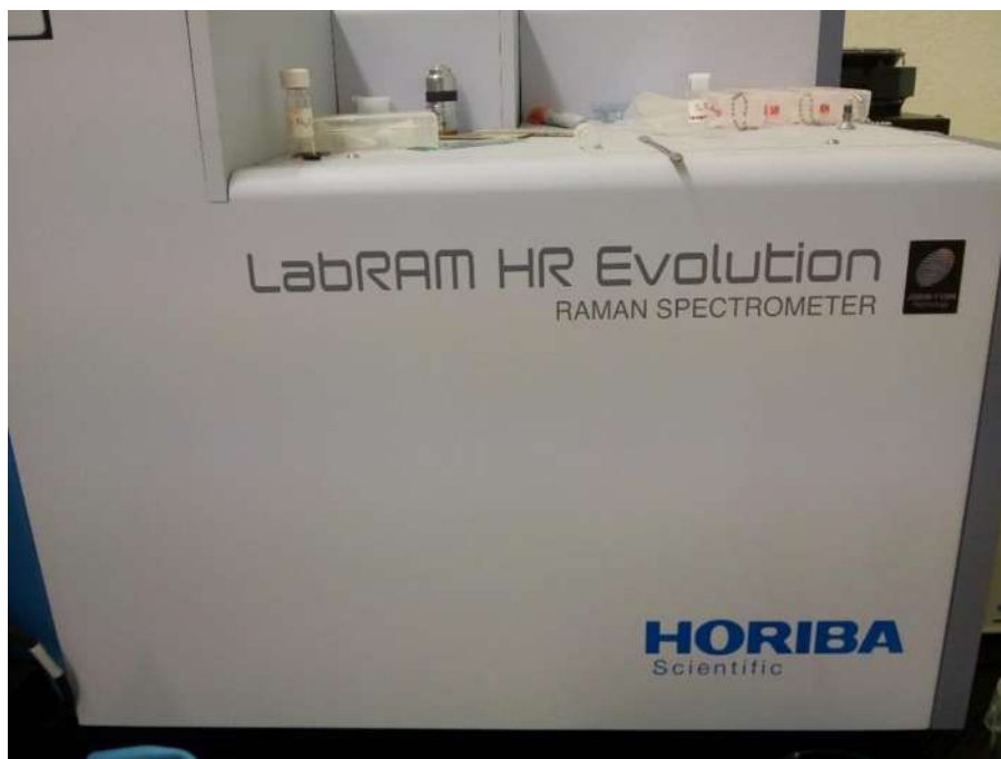
Fig. 60. Espectrofotómetro Raman utilizado para caracterizar los NTC de este proyecto
