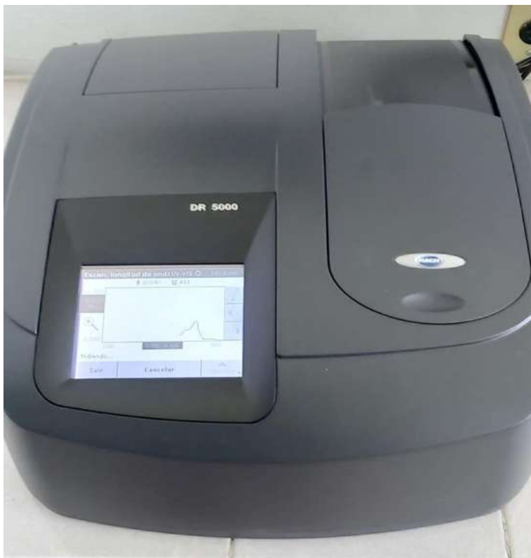
Fig. 77. Espectrofotómetro UV-Vis utilizado para análisis la absorbancia de las muestras con colorante
