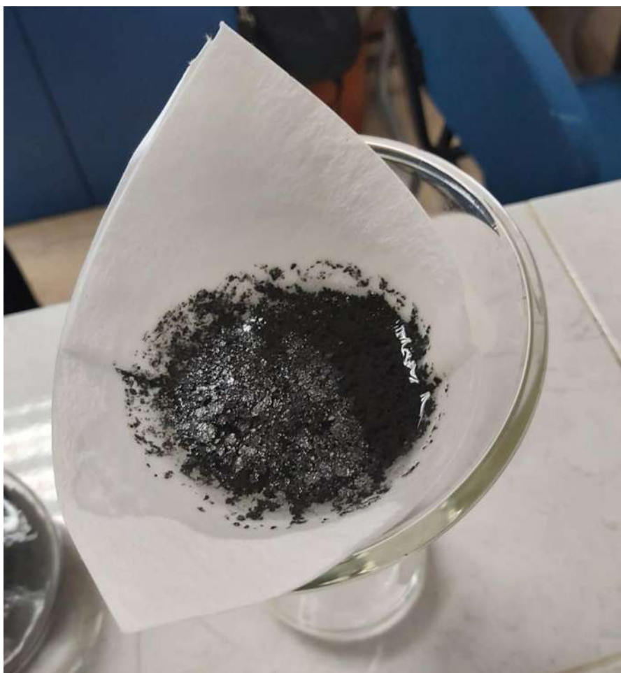
Fig. 49. Filtración de los NTC tratados con HCl
