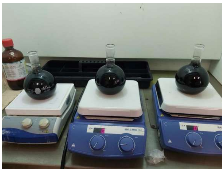
Fig. 48. Solución de NTC puros con 100 ml de HCl concentrado en constante agitación
