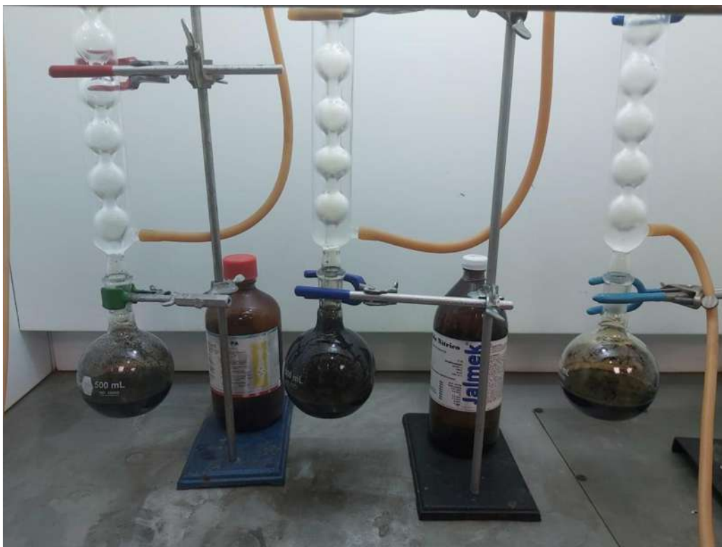
Fig. 52. Tiempo de espera en lo que el vapor de ácido condense y se enfríen los matraces para poder filtrarlos
