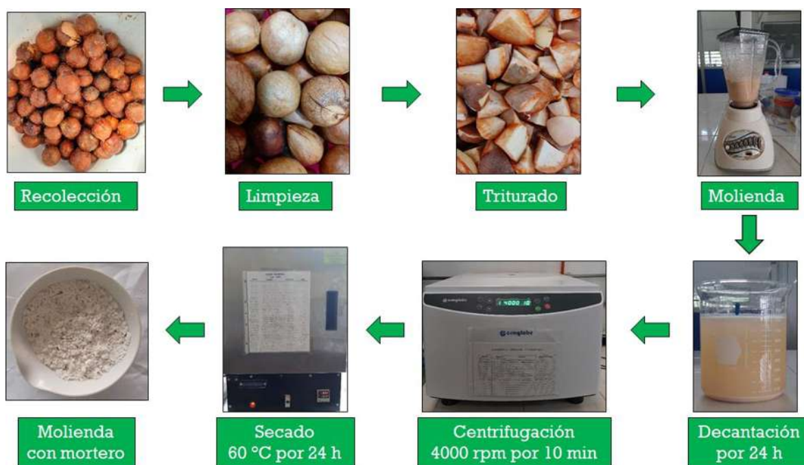
Figura 3.2. Proceso de extracción de almidón de semilla fresca de aguacate.
