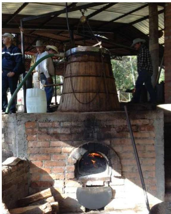
**Imagen 30.** Destilado de mezcal en alambique hecho de madera y acero inoxidable
