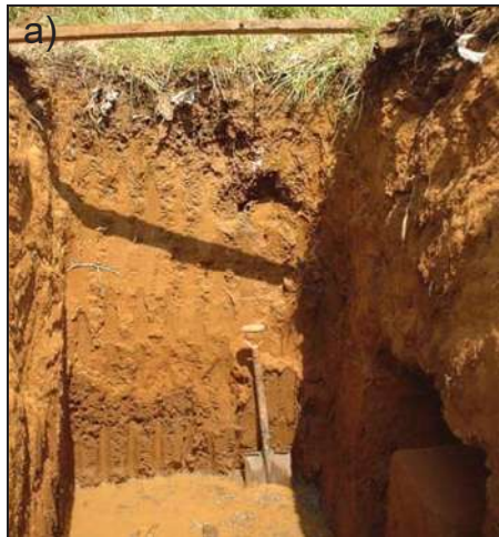
Figura 4.3.1.4. Excavación de la calle 1ª de Ascensión, a) se puede apreciar un solo estrato de material de apariencia limosa, b) detalle de la toma de muestra inalterada del suelo.
