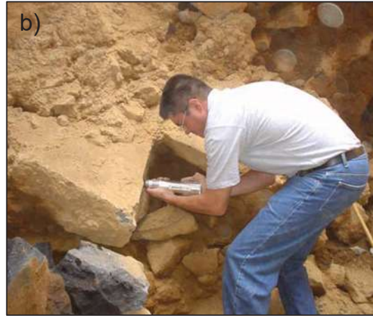
Figura 4.3.1.3.- Excavación en calle Espejo, a) aspecto general de la excavación en donde se puede apreciar el tamaño de las rocas, así como su forma, b) detalle de la prueba de resistencia con esclerómetro.
