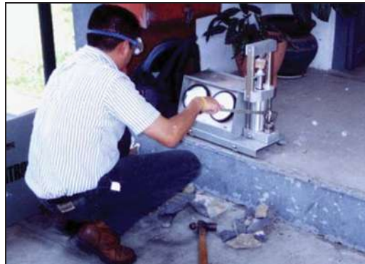
Figura 4.3.4.3.- Ensaye de una muestra de roca por medio de la prueba Point Load (Carga Puntual).
