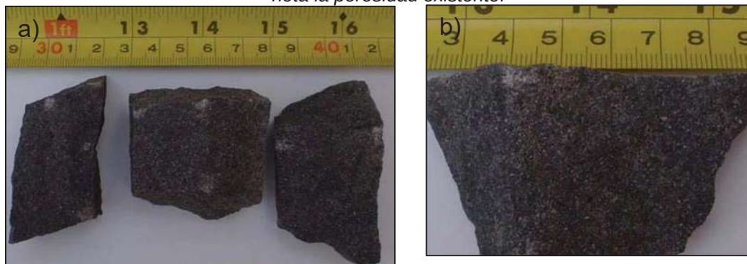
Figura 4.3.4.1. a).-Muestras de rocas de la calle Espejo. b).-Detalle de una roca donde se nota la porosidad existente.
