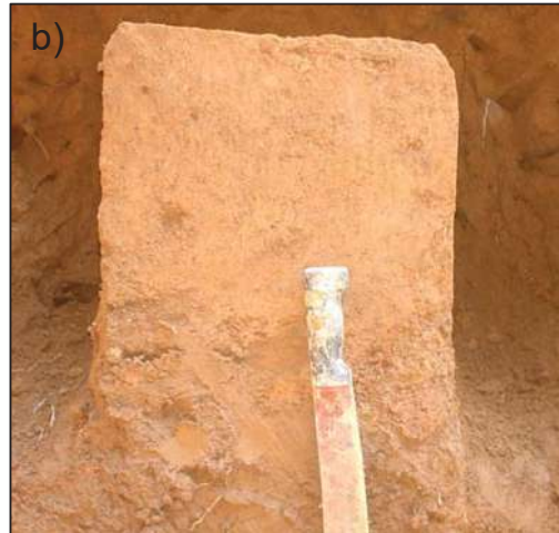
Figura 4.3.1.4. Excavación de la calle 1ª de Ascensión, a) se puede apreciar un solo estrato de material de apariencia limosa, b) detalle de la toma de muestra inalterada del suelo.
