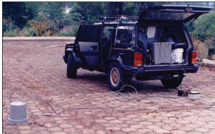
Figura 4.2.1.2.- Estación de trabajo, en donde se muestra el sensor cubierto por la cubeta, la antena de GPS sobre el toldo del vehículo y el equipo de registro así como las baterías en la parte posterior de éste.
