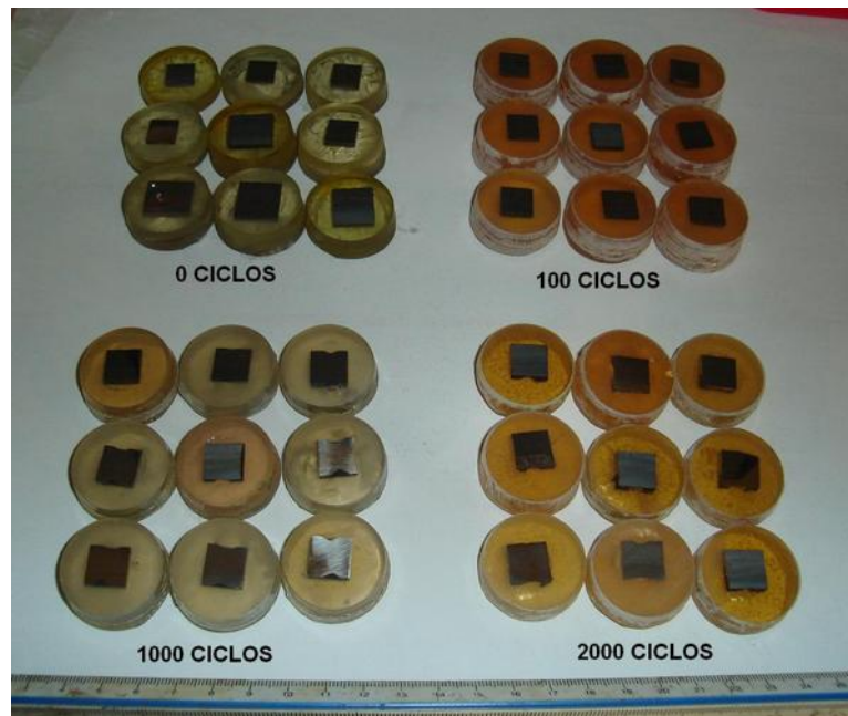
Figura 3.17 Muestras para metalografía
