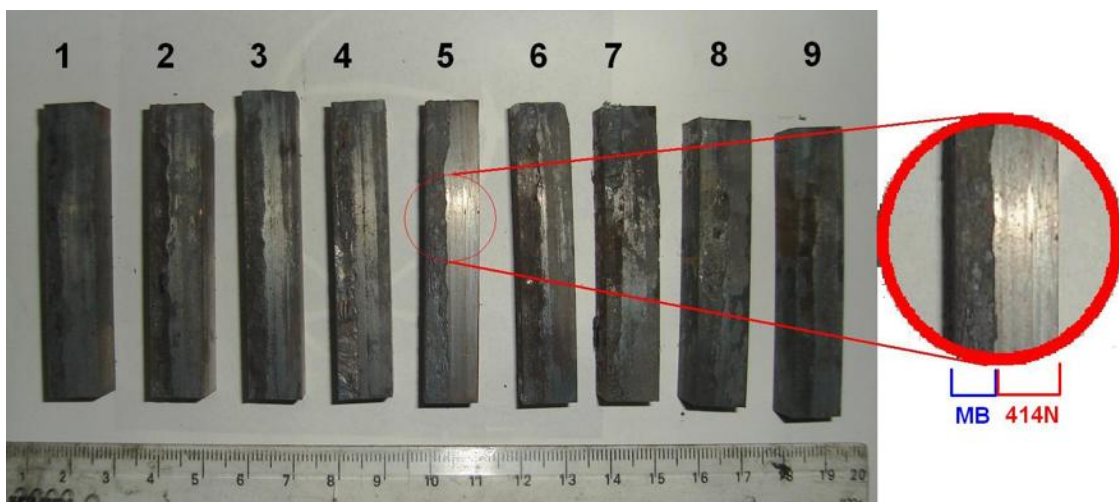
Figura 4.20 Probetas después de 1000 ciclos térmicos
