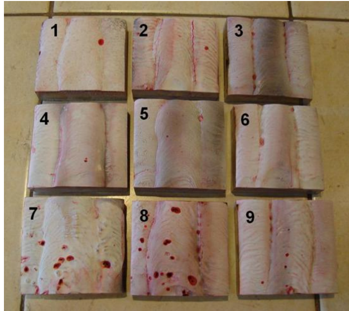
Figura 3.7 Aplicación del ensayo de líquidos penetrantes en recargues
