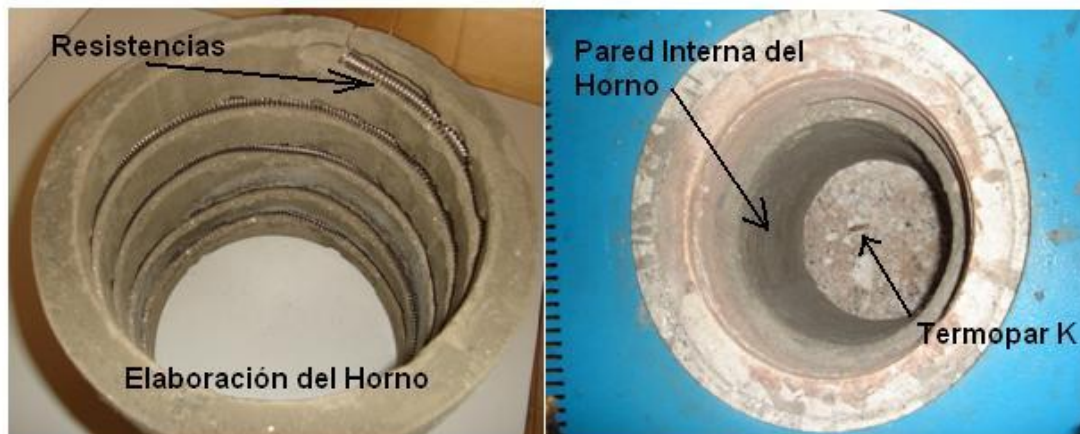
Figura 3.10 Elaboración del horno
