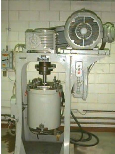
Figura 5. Molino UP-S Atricionador.
