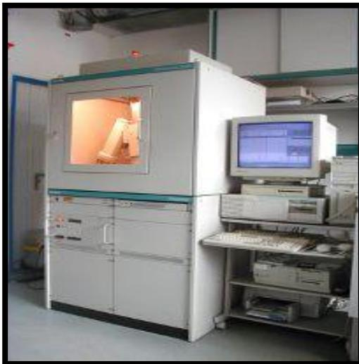
Figura 3. Imagen del Difractómetro de Rayos X (SIEMENS D-5000) utilizado para la caracterización de los polvos.
