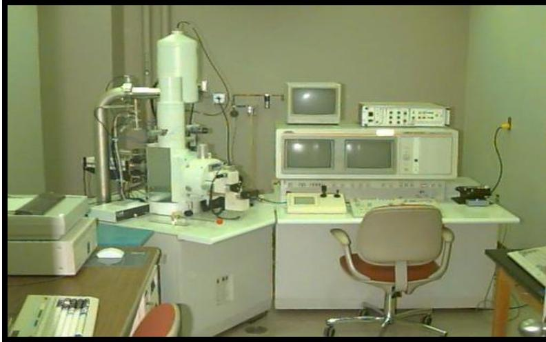
Figura 2. Imagen del Microscopio Electrónico de Barrido (JEOL JMS-6400) utilizado en la caracterización de los polvos.
