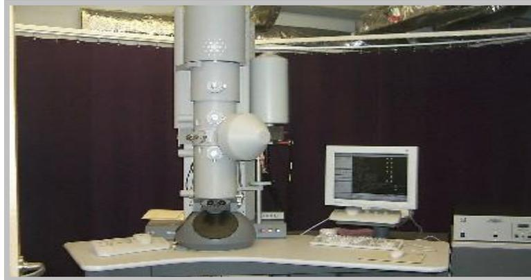
Figura 1. Imagen del Microscopio Electrónico de Transmisión (PHILLIPS TECNAI F-20), la particular característica de tener emisión de campo electrónica es muy especial que permite concentrar el haz hasta en un área de aproximadamente 10 nm.
