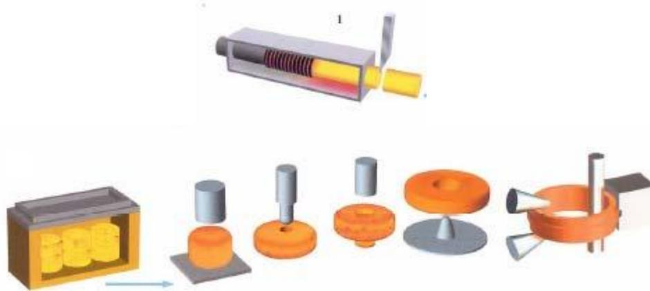
Figura 2.13 Diagrama esquemático de la secuencia de fabricación de anillos de acero por medio de una laminadora radial-axial.
