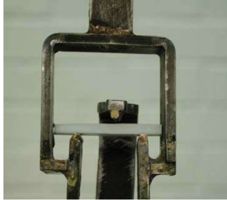
Fig. 2.7. Pruebas de flexión en tres puntos.
