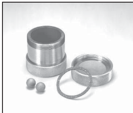
Figura 1.8. Vial y medios de molienda de WC [15].
