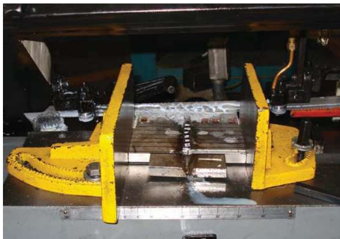
Fig. 2.17 Proceso de corte con sierra cinta de las probetas soldadas de acero AISI 304L.
