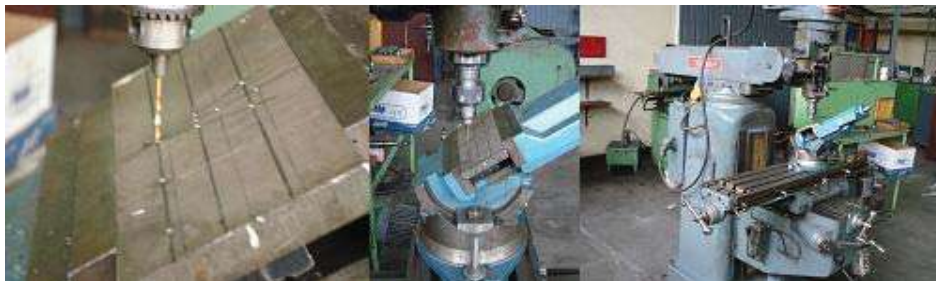
Fig. 2.3. Maquinado de las probetas de acero inoxidable.
