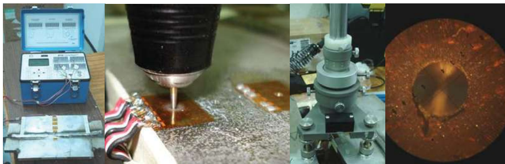
Fig. 2.15 Detalles de la la técnica de hole drilling para medición de esfuerzos residuales.
