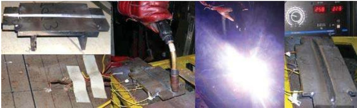
Fig. 2.10 Detalles de la soldadura de la probeta 1.
