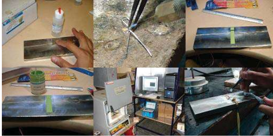
Fig. 2.7. Detalles del procedimiento de fijación de la galga de alta temperatura.
