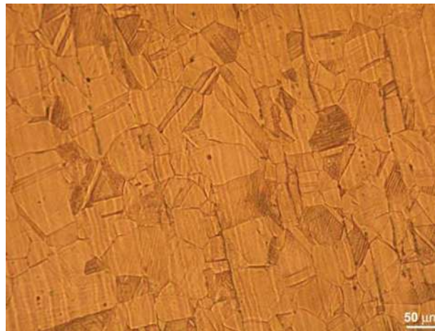
Fig. 2.1 Microestructura austenítica con pequeñas vetas de ferrita de la sección transversal de la placa de acero inoxidable AISI 304L utilizada.
