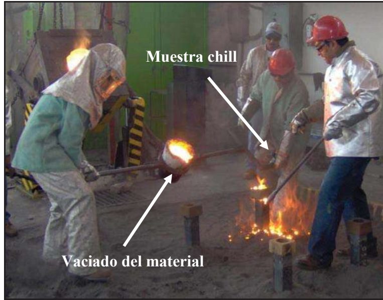
Figura 3.3. Aspecto del proceso de vaciado así como el de recolección de las muestras chill.
