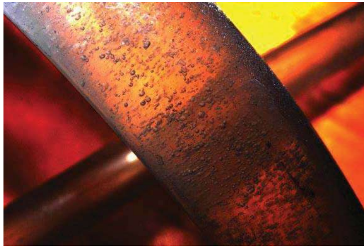
Figura 4.11 Burbujas atrapadas en el flujo de colas
