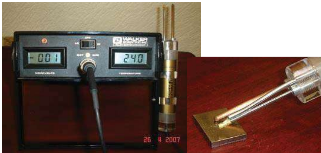
Figura 2.5 ThermoSorter (Walker Scientific, Inc.) y forma en la que se realiza la medición.
