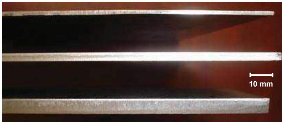
Figura 2.1 Láminas utilizadas en la experimentación de 1.6 mm, 3.2 mm y 6.4 mm de espesor respectivamente.
