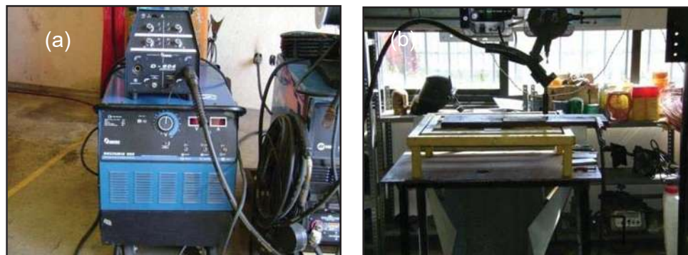
FIGURA 13. (a) Fuente de potencia y (b) electrodo de soldadura.
