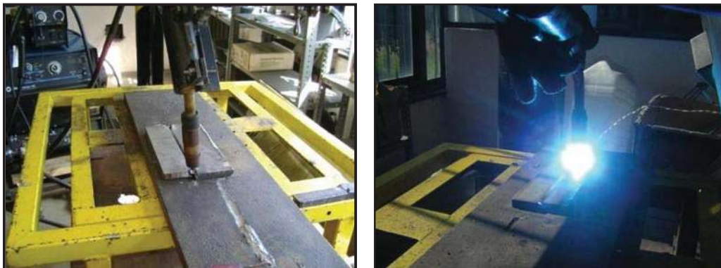
FIGURA 16. Ejecución del proceso de soldadura tipo MIG.
