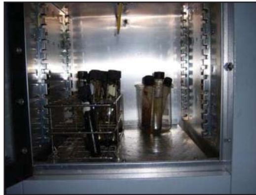
FIGURA 21. Exposición de las probetas a 10, 20, 30 y 60 días, en el horno a 70° C.
