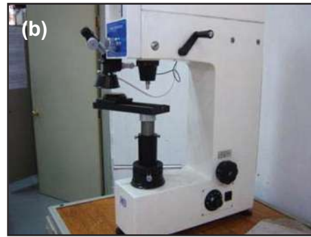
FIGURA 26. 26(a) Probeta para la realización de pruebas de dureza Vickers y 26(b) Equipo para realizar las pruebas Vickers.
