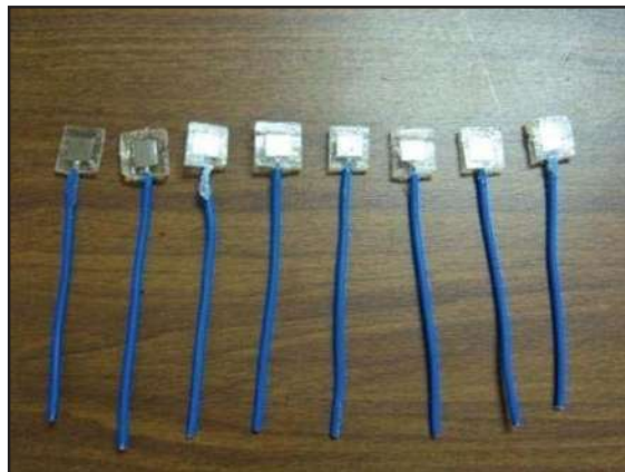
FIGURA 20. Probetas encapsuladas (electrodos de trabajo) para la elaboración de pruebas electroquímicas.
