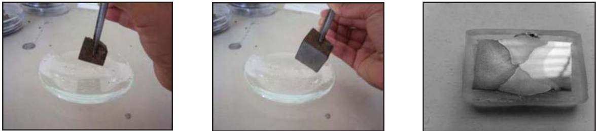
FIGURA 18. Ataque químico y revelado de las fases en las muestras de acero.
