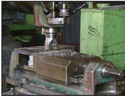
FIGURA 15. Elaboración del bisel en las placas de acero
