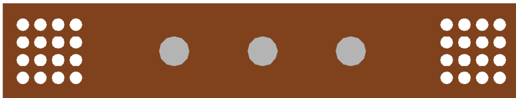
Figura 2.4.- Probeta de cobre con inclusiones metálicas de estaño.
