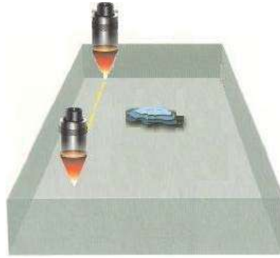
Figura 2.17. -Esquema de Barrido (lineal).
