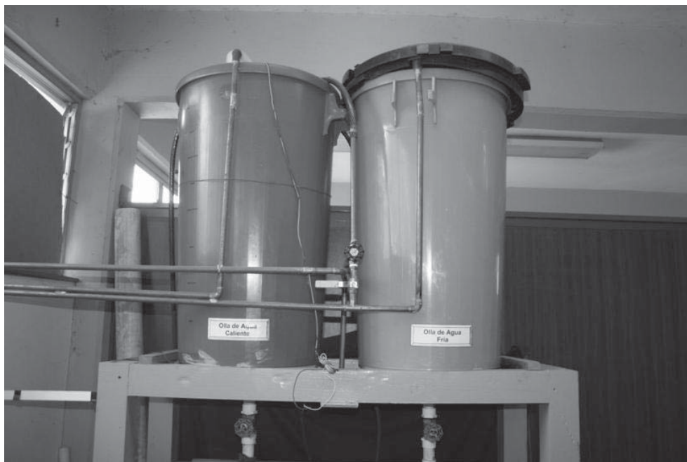
Figura 3.12 Tanques de plástico que simulan ollas de colada.
