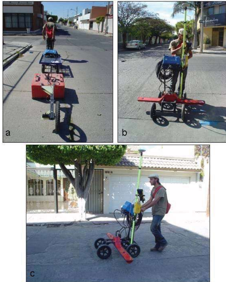
Figura 34. Levantamiento GPR con antenas de 200 (a), 70 (b) y 40 (c) MHz.
