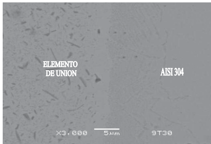
Figura 4.7 Sección transversal de la zona de unión AISI 304/c.amorfa/AISI304 unida a 900 °C por 30 minutos, a) 1 000 X, b) 2 000 X, c) 3 000 X en una atmósfera de Ar.
