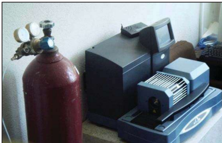
Figura 3.2 Analizador térmico diferencial modelo SDT Q600.
