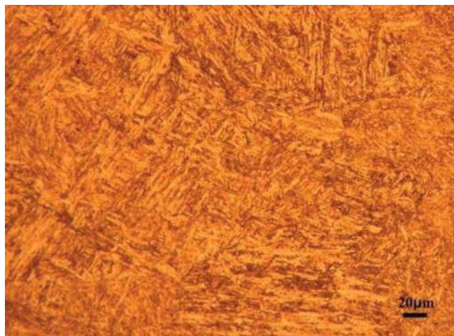
Figura 3.4. Micrografía del recargue de acero 410 con 6% N 2 y 0 horas, mostrando una estructura martensítica. (200X, villelas y 20 segundos).
