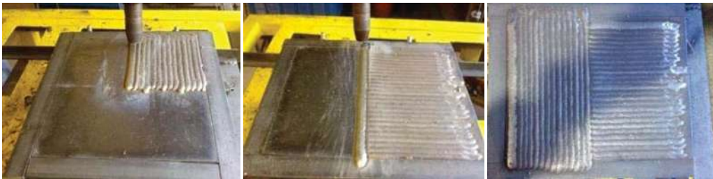
Figura 2.3. Secuencia de aplicación del enmantequillado de acero inoxidable austenítico AISI 309.
