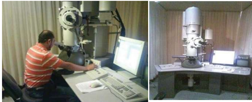
Figura 2.14. Microscopio electrónico de transmisión Philips Tecnai F20.
