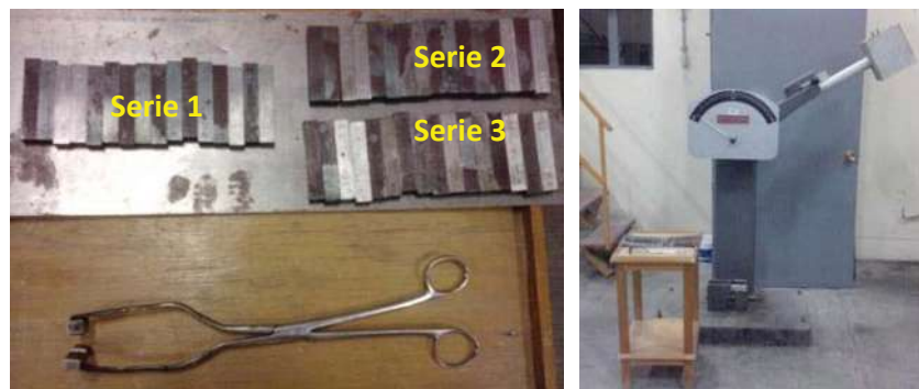
Figura 2.10. Probetas para ensayo de impacto y equipo para ensayo Charpy.
