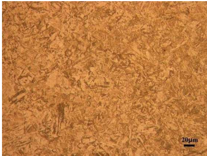
Figura 3.9. Micrografía del recargue de acero 410 con 3% N_2 y 12 horas, mostrando una estructura martensítica. (200X, villela y 45 segundos).
