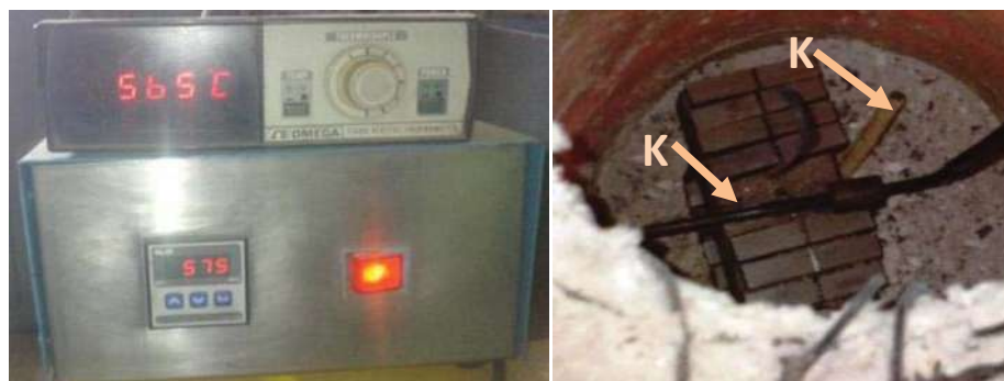
Figura 2.8. Registradores de temperatura, termopares tipo K.
