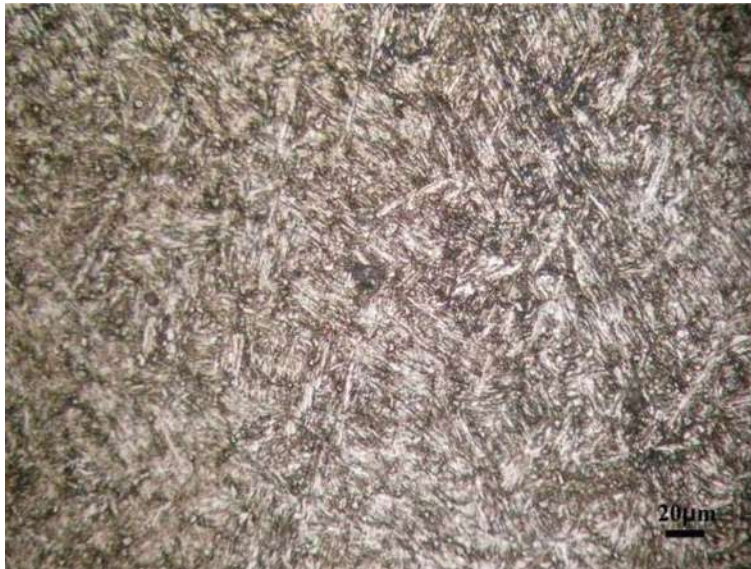
Figura 3.7. Micrografía del recargue de acero 410 con 6% N 2 y 2 horas, mostrando una estructura martensítica. (200X, vellelas y 120 segundos).
