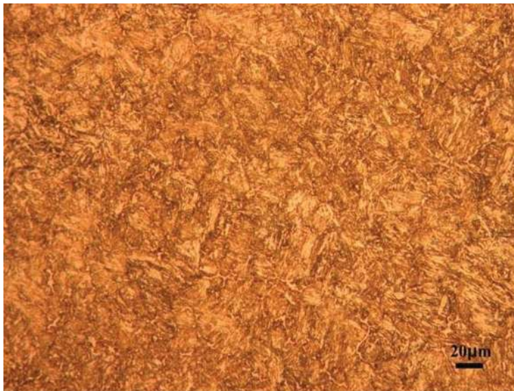
Figura 3.11. Micrografía del recargue de acero 410 con 0% N 2 y 24 horas, mostrando una estructura martensítica. (200X, vellelas y 30 segundos).
