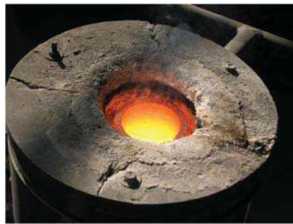
(a) Horno de inducción y crisol utilizado para la fundición.
