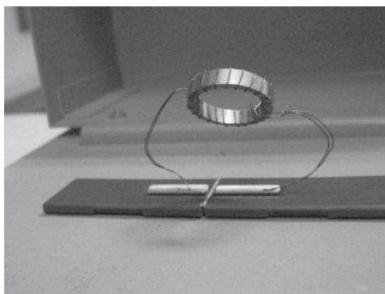
Fig. 3.15. Anillo embobinado conectado a los bornes de conexión del analizador de impedancia.
