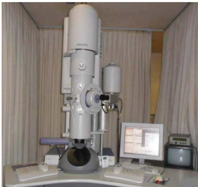
Fig. II.7 Microscopio electrónico de transmisión Phillips Tecnai F20
