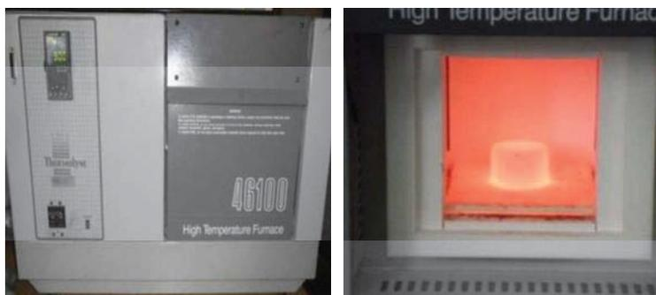
Fig. II.11 Horno Inductotherm 46100 de sinterización y con la muestra
