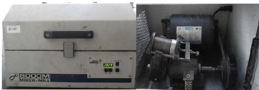
Fig. II.4 Molino SPEX 8000M
