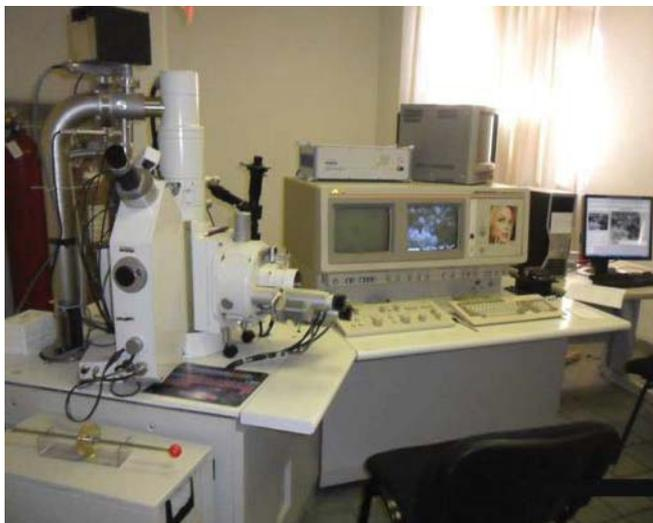
Fig. II.6 Microscopio electrónico de barrido JEOL 6400
